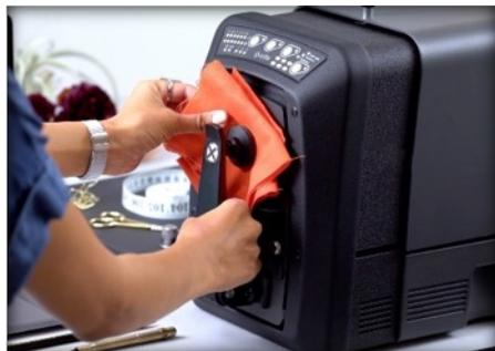
Medición de muestras con el espectrofotómetro Ci7800 de X-Rite
